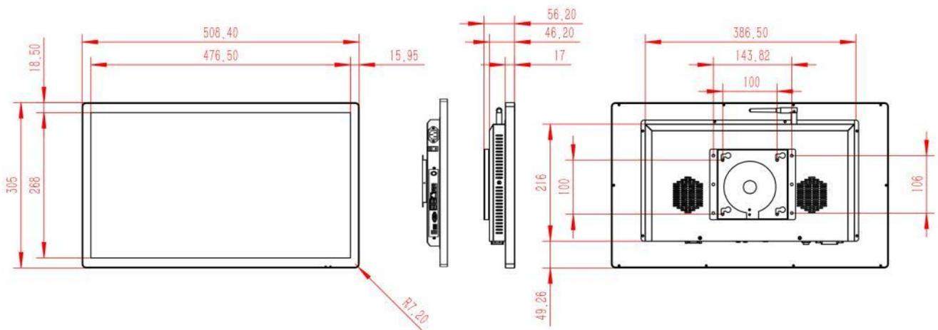
21.5 寸壁挂广告机尺寸图（非触摸）注：如安装环境严苛、更详细尺寸请咨询客服
